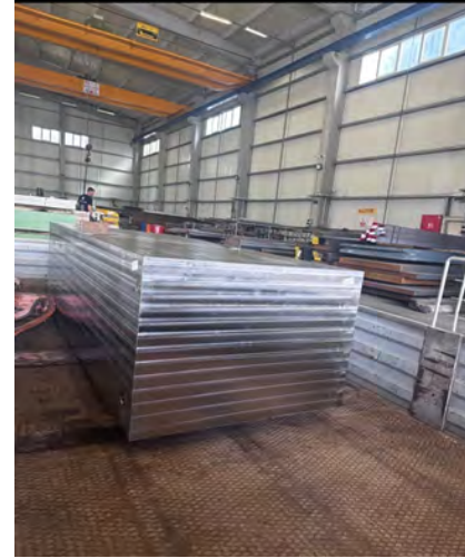
TOFAŞ /STALENTIS Projesi için Plastik Kalıp Çeliği 1.2738 850X1250X2750
