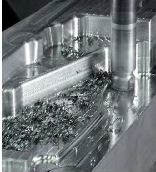
Kaba işlemeden geçirilen 2312'den yapılmış ana parça
