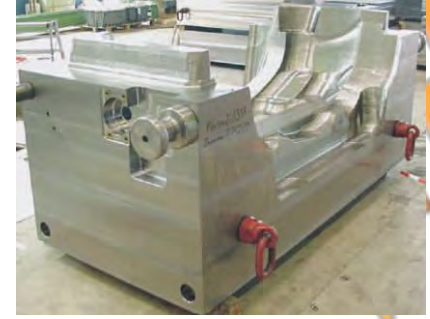
Araba Tampon Kalıbı (1160 x 1010 x 2700 mm, ağırlık 22 metrik ton)
